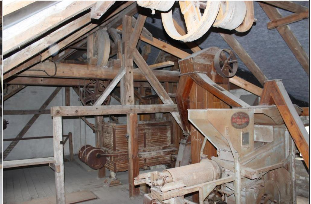
**Innenansichten - Sichterboden:** Saugfilterschrank, Flachsichter; Flachsichter, Kopf des Annahmeelevators, Reinigungsmaschine
