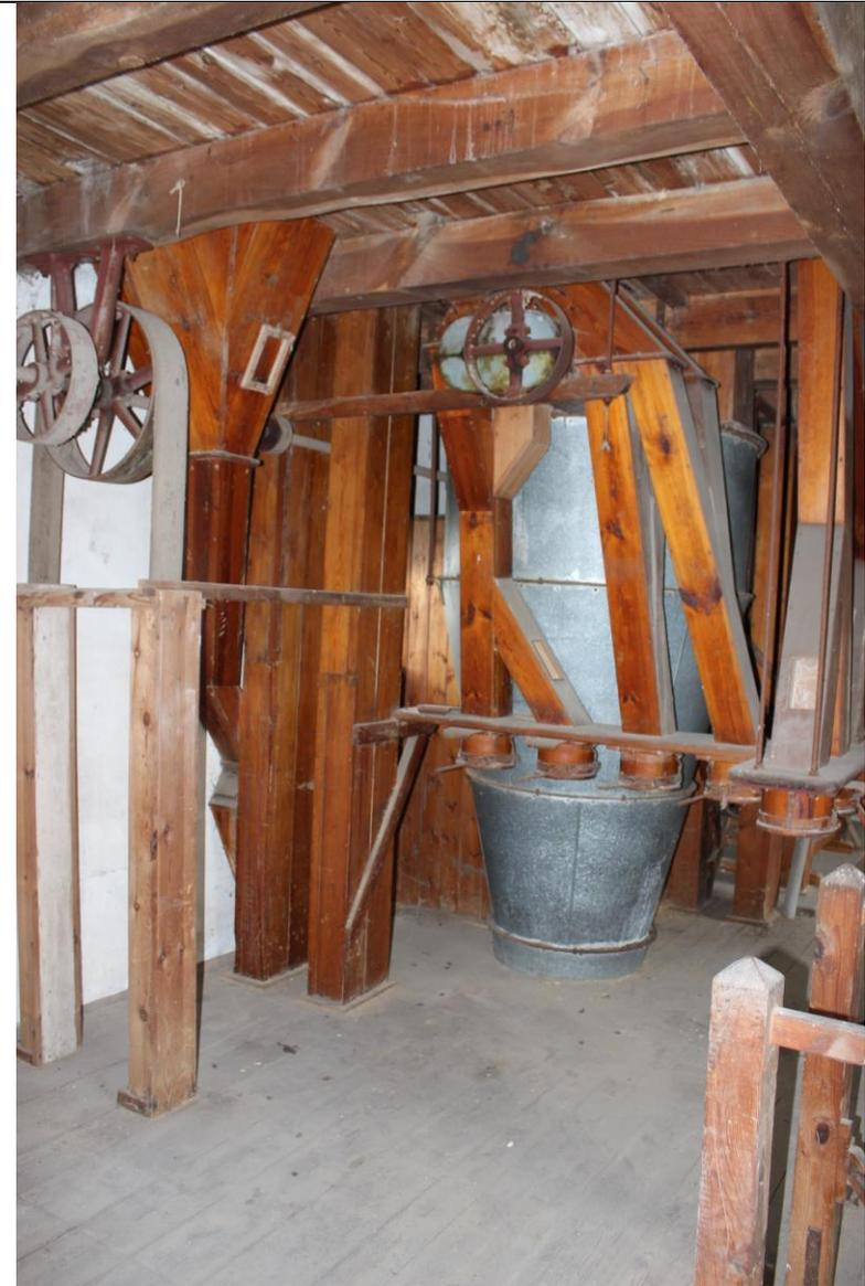
**Innenansichten - Behälterboden:** Auslauf Filterschrank, Passagenelevator, Sackbank mit dahinter liegendem Wunderwald-Trichter
