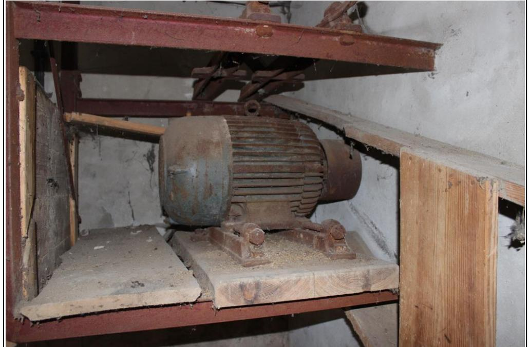
**Innenansichten - Mahlboden:** Elektroantriebe für Mahlsystem (oben, fehlt) und Schrotgang (unten); Elektromotor zum Antrieb des Schrotgangs
