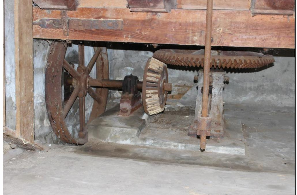
**Innenansichten - Mahlboden:** Schrotgang mit Steinkran; Detail Antrieb des Schrotgangs
