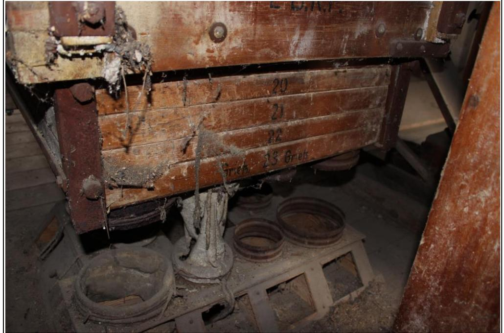
**Innenansichten - Sichterboden:** Einlauf Flachsichter mit Rohrweiche; Auslauf Flachsichter
